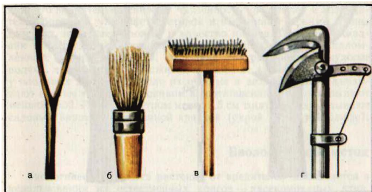
Рис. 2. Приспособления для работы с деревьями: а – рогатка; б, в – щетка; г – воздушный секатор.
