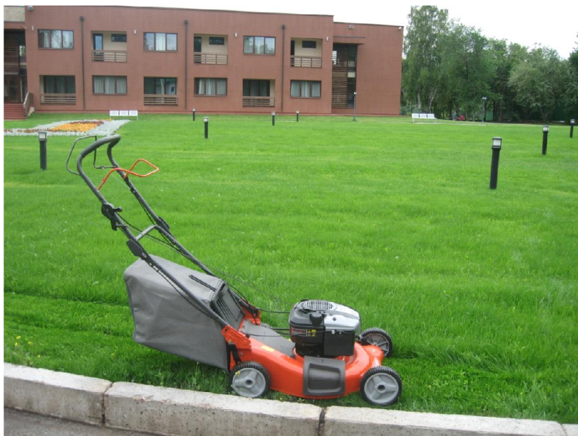
Самоходная газонокосилка с бензиновым двигателем и травосборником
